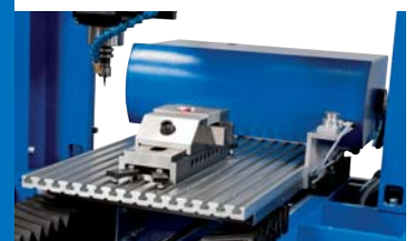
6-fach-Magazin geschützt im Gehäuse, BZT PFX 6-times magazine protected in the housing, BZT PFX
